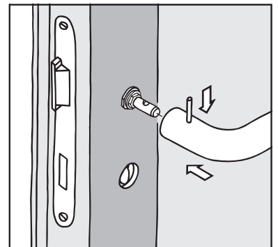
6. Griff aufstecken. Stift mit leichtem Hammerschlag bündig einsetzen.
